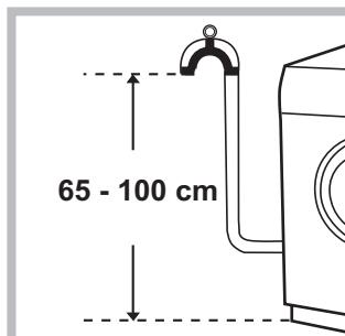
Подсоедините сливной шланг, не перегибая его, к сливной трубе или к настенному сливному отверстию, расположенному на высоте от 65 до 100 см от пола,
